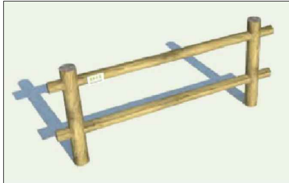
DETALLE TALANQUERA DOBLE
